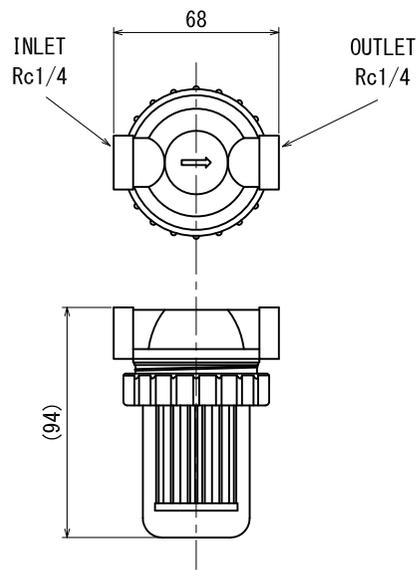
フィルターろ過精度 20μm
